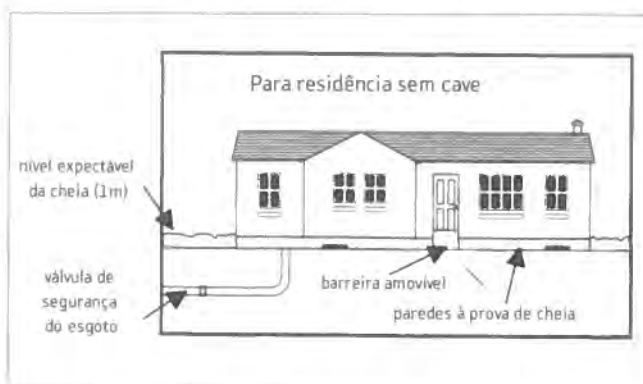
FIGURA. 44 – Viver com as cheias: exemplo de medidas de protecção em residência afectada por cheias frequentes mas não destruidoras (Smith e Ward, 1998, modificado).
